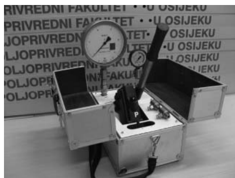
Slika 2. Komparator tlaka Volos
