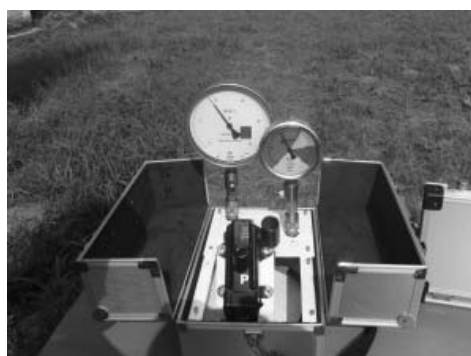
Slika 2. Komparator tlaka Volos
