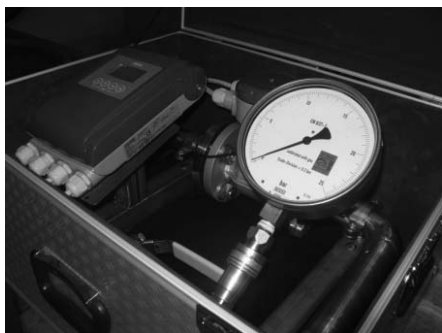
Slika 1. Elektromagnetni mjerač kapaciteta crpke tvrtke Krohne
