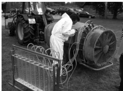
Slika 3. Uređaji za mjerenje protoka mlaznica
