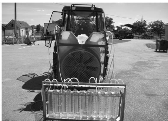
Slika 3. Menzure za mjerenje protoka mlaznica raspršivača
