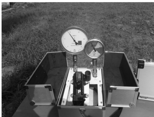
Slika 2. Komparator tlaka Volos
